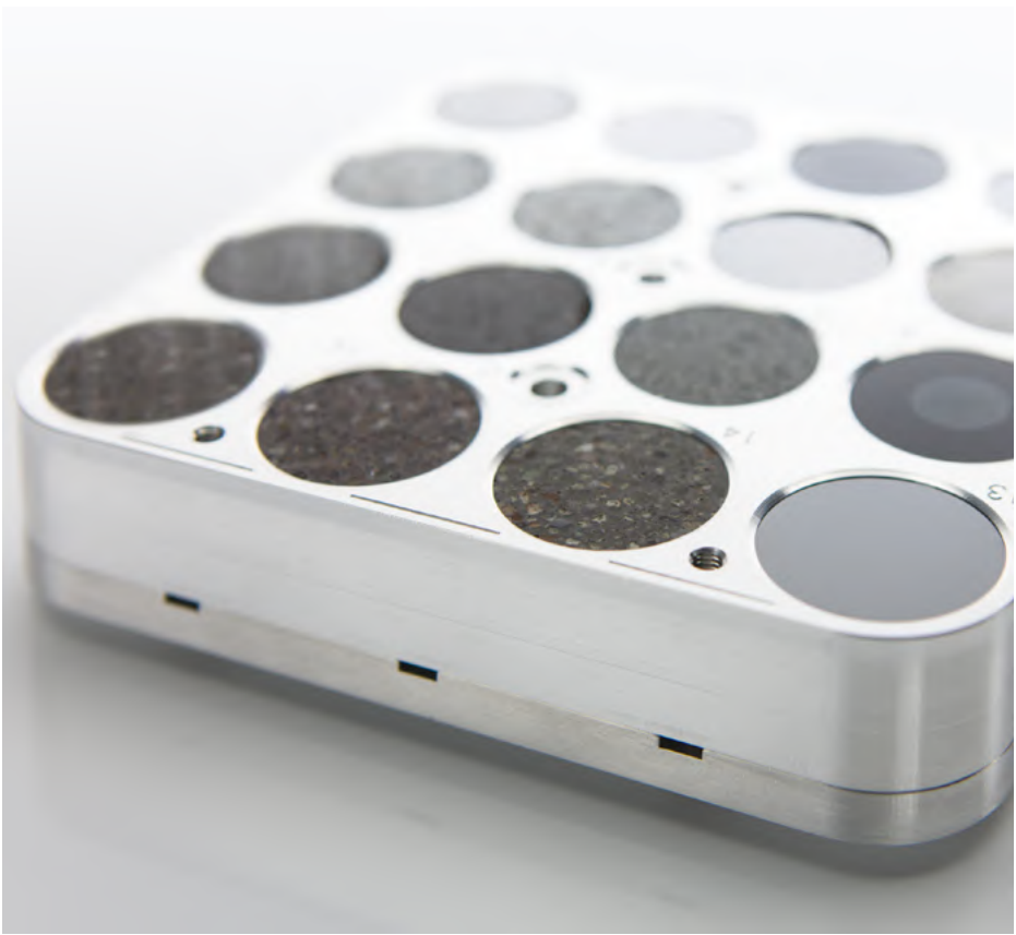
Figura 28: Briqueta de mineral para análisis
