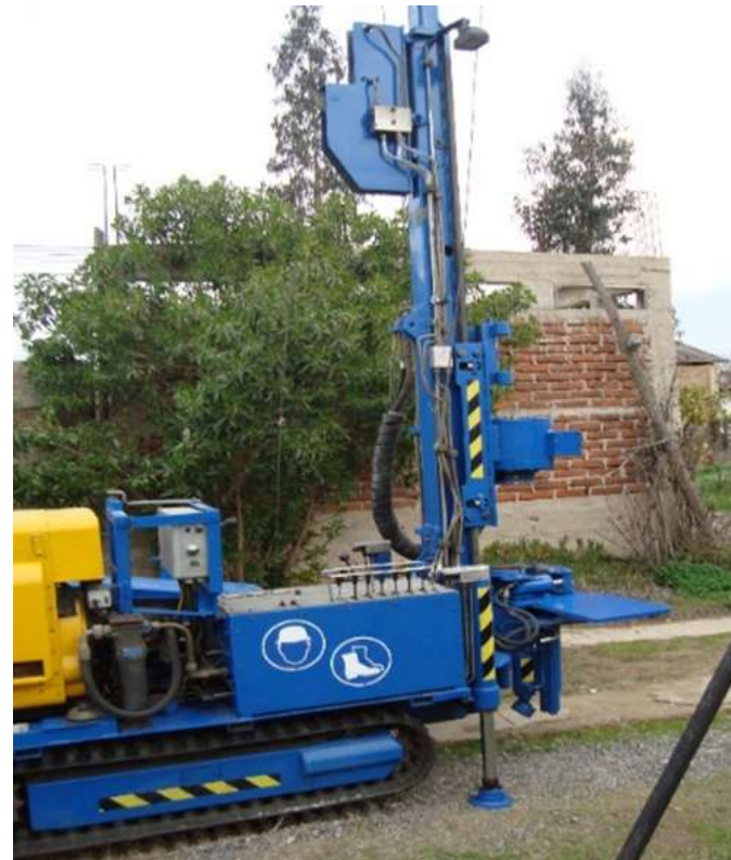
Figura 12. Máquina Auger Drilling montada en oruga
