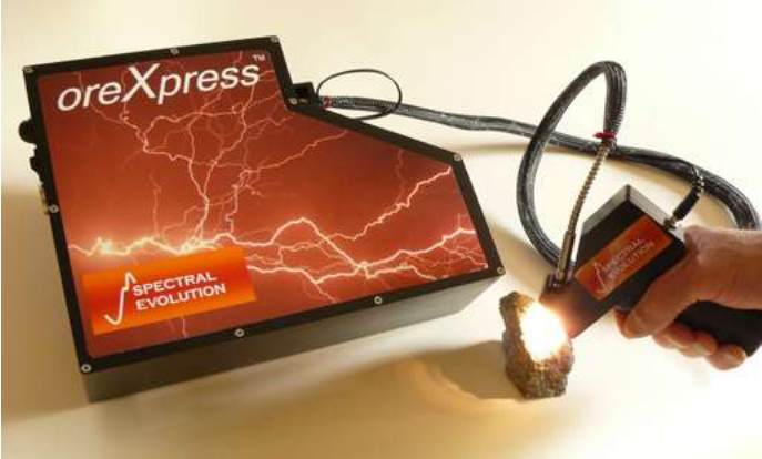
Figura 30: Equipo portátil de espectroscopia infrarroja cercana
