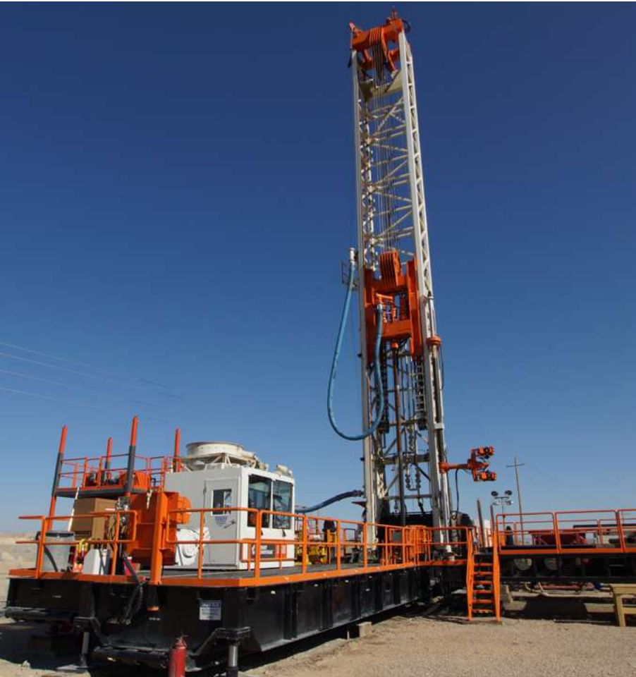
Figura 7 Izq.: Maquinaria sondaje de diamantina
