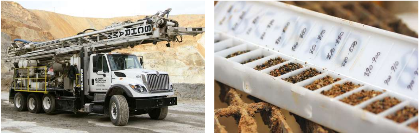
Figura 5, Izq.: Maquinaria de Sonda de Aire Reverso. Der.: Muestras obtenidas mediante sonda de Aire Reverso
