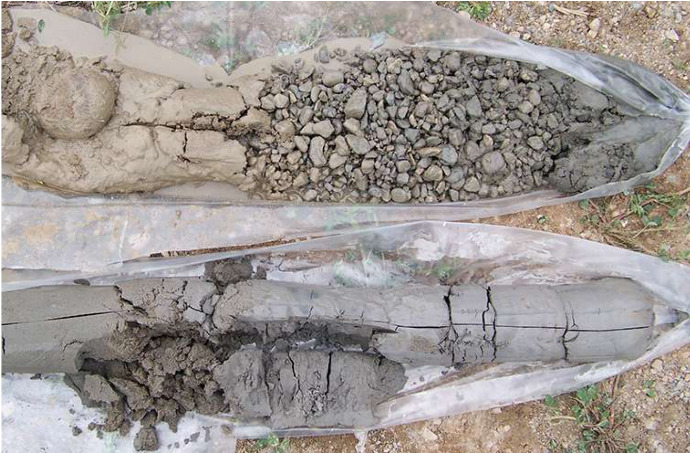
Figura 10: Muestras obtenidas en sondajes con sonda sónica
