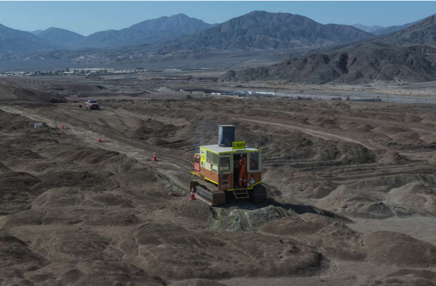
Figura 11: Maquinaria Fugro Sondaje CPT-FRX
