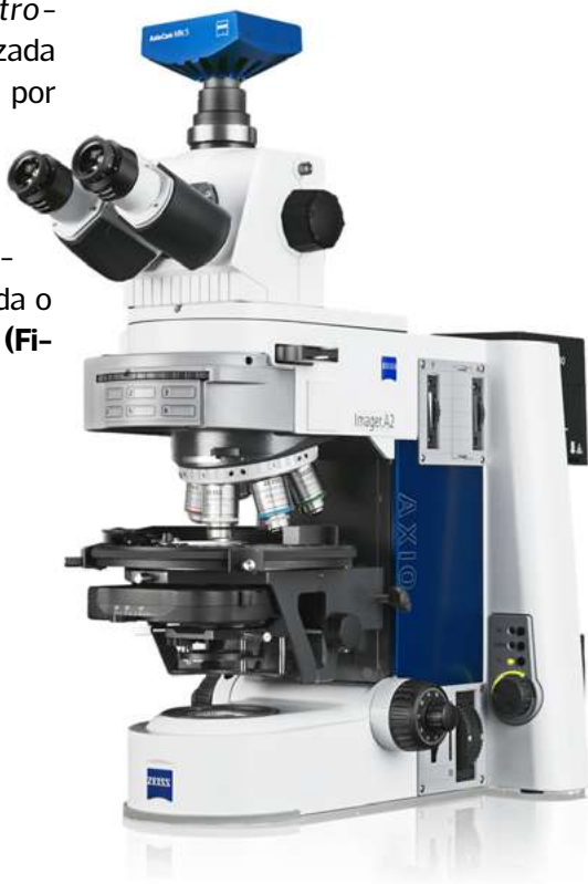
Figura 25: Microscopio de luz polarizada para identificación de minerales
